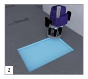
À l'aide d'une fraiseuse, faire une engravure dans la zone marquée. La profondeur dépend de l'épaisseur de la platine. Considérer une augmentation de l'épaisseur par la couche de colle de 2 mm.
