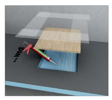
Pour fixer des objets lourds (radiateurs, meubles) il faut impérativement prévoir une platine de fixation (voir système de pose ci-dessous).
