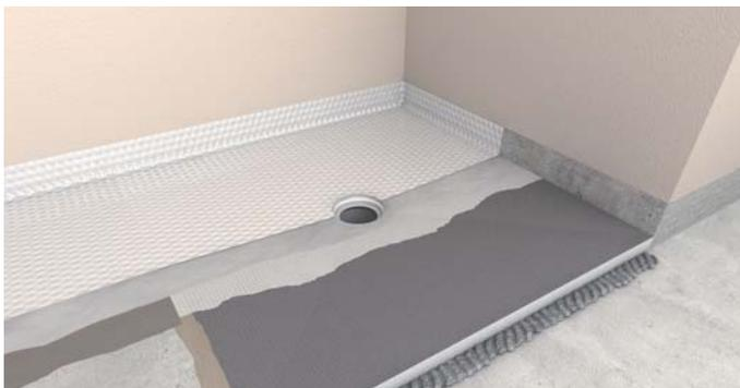
Le receveur wedi Solso est le support idéal pour les douches pourvues d'un revêtement PVC. Son noyau est constitué d'un polystyrène rigide et très dense. La surface du receveur est constituée d'un revêtement spécial armé d'une trame en fibre de verre.
