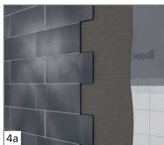
4a Les panneaux de construction peuvent être appliqués uniquement sur l'ancien carrelage ou...
