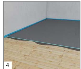
4 Noyer le panneau de construction dans la colle en décalant les joints.
