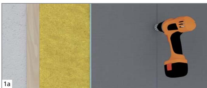
1a À l'aide de vis à fixation rapide ou de vis à bois et de rondelles d'isolation wedi *Tools*, visser entièrement le panneau de construction sur la structure métallique ou sur la structure en bois...
