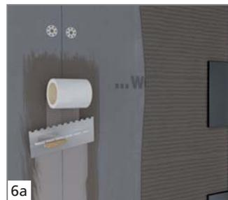
6a Appliquer de la colle à carrelage aux jonctions des panneaux de construction et installer la bande d'armature wedi *Tools*. Ensuite façonner la surface comme d'habitude.
