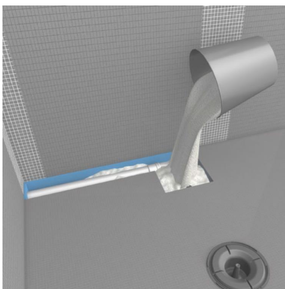
Figure 16 : comblement au mortier de calage à prise rapide avec un receveur Fundo Plano
