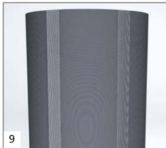
9 Prévoir la pose de bande d'armature wedi Tools sur les jonctions à l'intérieur et à l'extérieur.
