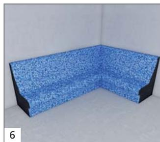
6 Les banquettes sont recouvertes d'un carrelage de petite dimension (2 x 2 cm ou 2,5 x 2,5 cm), afin d'épouser facilement les formes courbes de la banquette.
