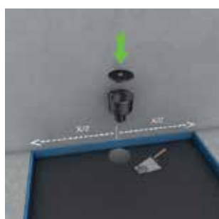
5/ Pour un écoulement vertical, raccorder le siphon et combler l'espace vide avec du mortier de scellement.
