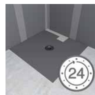
7/ Après 24 heures, commencer le traitement des jonctions.
